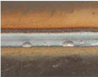
Dia: 1,2 mm Parameter: 222A, V= 24,6 V, vd= 7 m/min, vs= 40 cm/min
