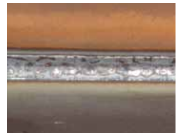
Dia: 1,2 mm Parameter: 361A, V= 28,6 V, vd= 13,5 m/min, vs= 80 cm/min
